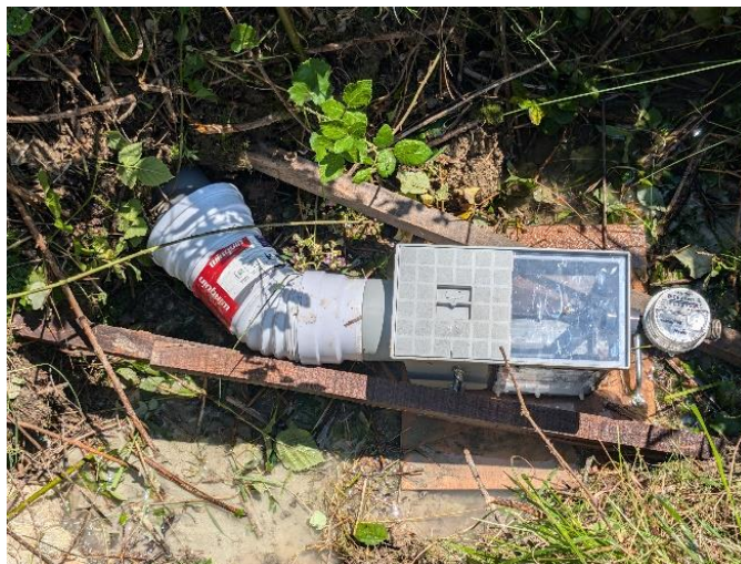
Boîte à périphton connectée à un drain
