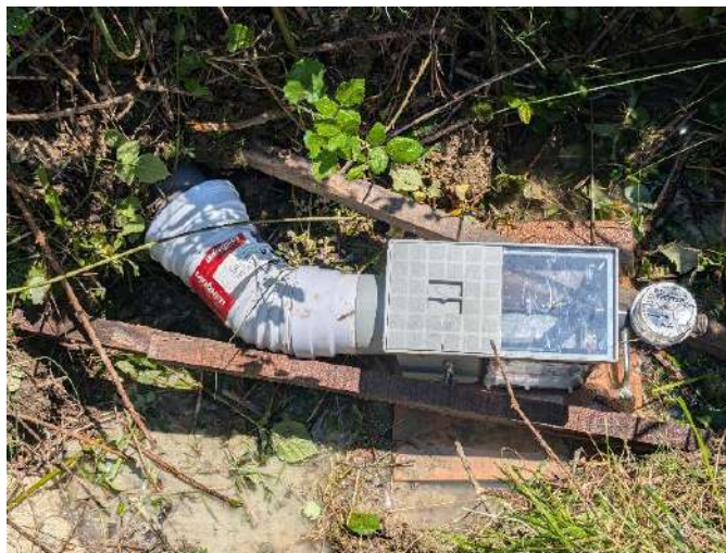
Boite à périphyton connectée à un drain
